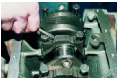
Метки на крышках коренных подшипников
