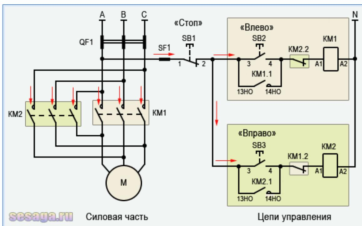
При этом разорвется цепь и управляющая фаза «А» перестанет поступать на катушку пускателя **КМ1**, возвратная пружина вернет сердечник
