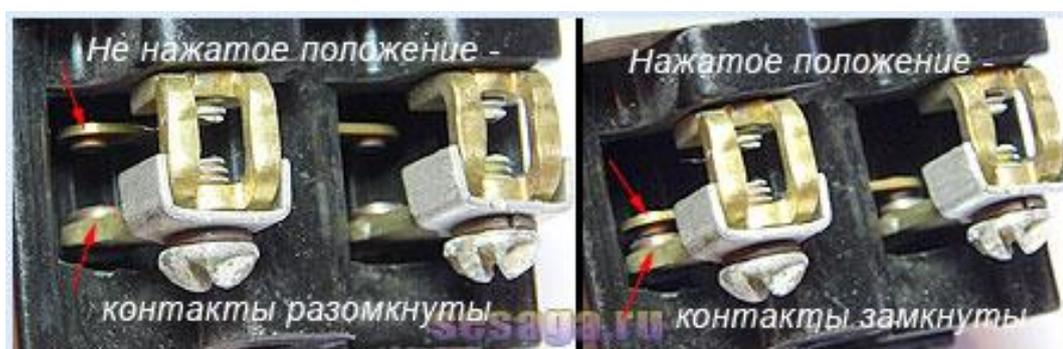
При нажатии на кнопку подвижный контакт опускается и замыкает оба неподвижных контакта. Когда же кнопка отпускается, то ее подвижный контакт под действием пружины возвращается в исходное верхнее положение и контакты размыкаются.
