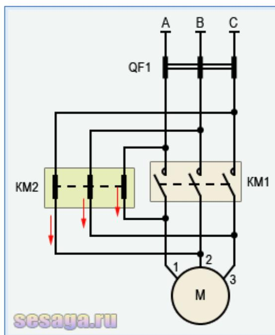
Обвязка силовых контактов пускателя **КМ2** выполнена таким-образом, что при его срабатывании фазы «В» и «С» меняются местами: фаза «В» через **средний** контакт подается на обмотку №3, а фаза «С» через **крайний левый** подается на обмотку №2. Фаза «А» остается без изменений.
