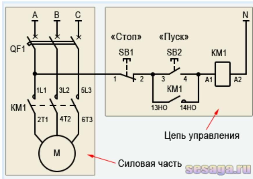
Для удобства понимания схема разделена на две части: **силовая часть** и **цепи управления**.
