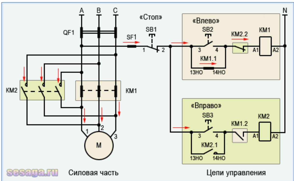
Здесь же, нормально-замкнутый контакт **KM1.2**, расположенный в цепи питания катушки пускателя **KM2**, размыкается и не дает включиться магнитному пускателью **KM2** пока в работе пускатель **KM1**.
