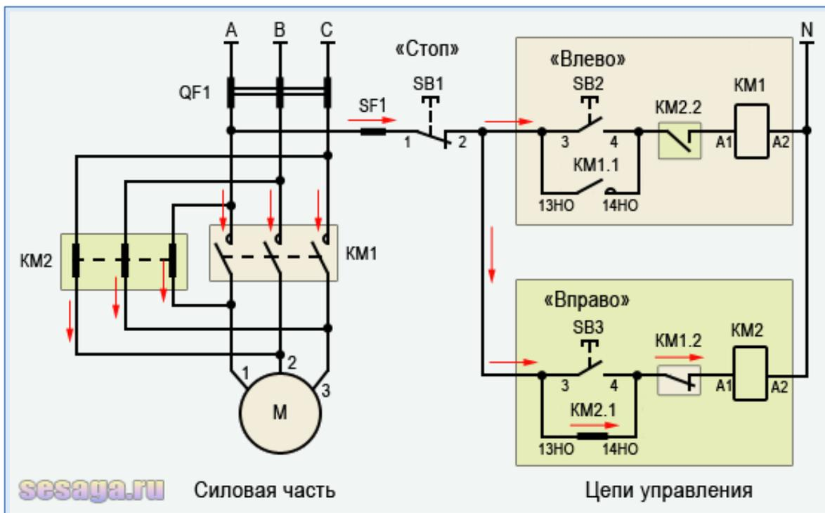
Нажимаем кнопку **SB3** и фаза «А» через нормально-замкнутый контакт **KM1.2** поступает на катушку магнитного пускателя **KM2**, пускатель срабатывает и через свой контакт **KM2.1** встает на самоподхват.
