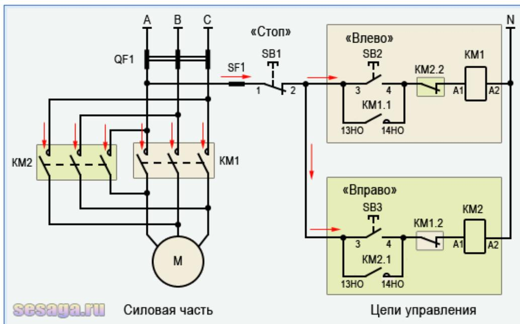
Фаза «А», питающая цепи управления, через автомат защиты цепей управления **SF1** и кнопку **SB1** «Стоп» поступает на контакт №3 кнопок **SB2** и **SB3**, вспомогательный контакт **13НО** пускателей **KM1** и **KM2**, и остается дежурить на этих контактах. Схема готова к работе.
