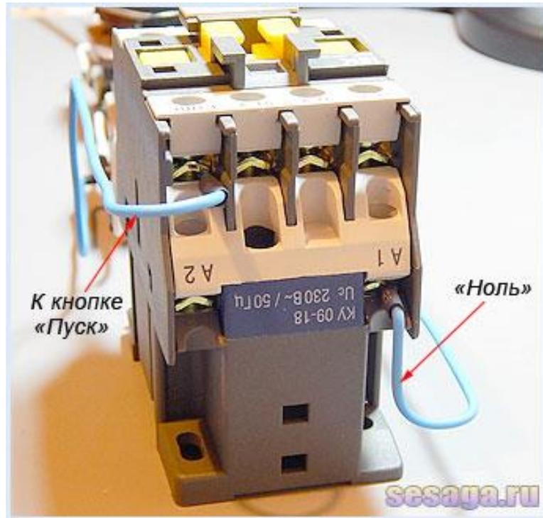
Чтобы не тянуть лишний провод на кнопку «Пуск», ставится перемычка между выводом катушки и одним из ближних вспомогательных контактов: в данном случае это «A2» и «14НО». А уже с противоположного вспомогательного контакта провод тянется непосредственно на контакт №3 кнопки «Пуск».
