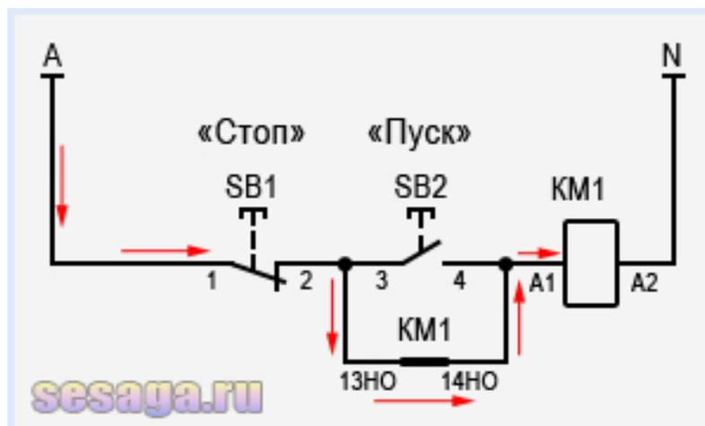
А если не будет самоподхвата, придется все время держать нажатой кнопку «Пуск» пока будет работать эл. двигатель или любая другая нагрузка, питающаяся от магнитного пускателя.
