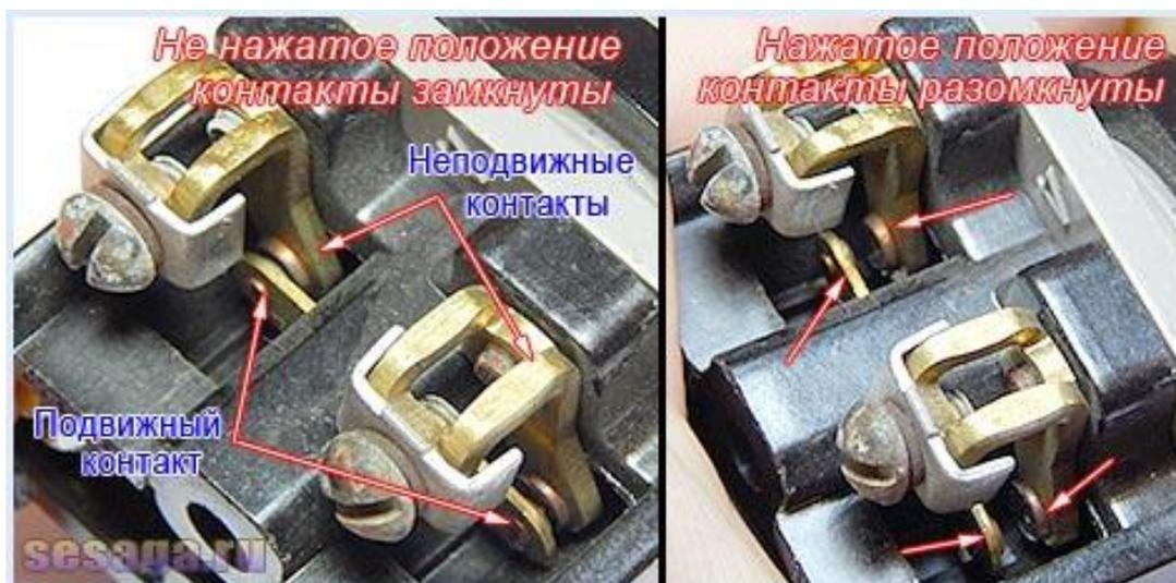
При отпускании кнопка опять возвращается в исходное положение пружиной, поддавливающей подвижный контакт, и он опять замыкает собой оба неподвижных контакта. На рисунке показаны контакты кнопки в нажатом и не нажатом положении.
