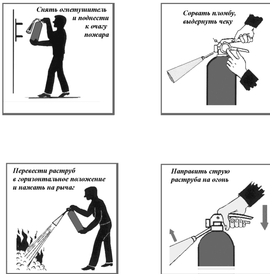
Рис. 8. Приведение в действие ручного углекислотного огнетушителя (плакат)
