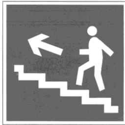
Направление к эвакуационному выходу по лестнице вверх
